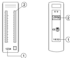
Bei Geräten nach dem Verdunstungsprinzip ist die Ablesung an der Unterkante des Flüssigkeitsspiegels, in Augenhöhe und am besten mit einer Taschenlampe, vorzunehmen.
